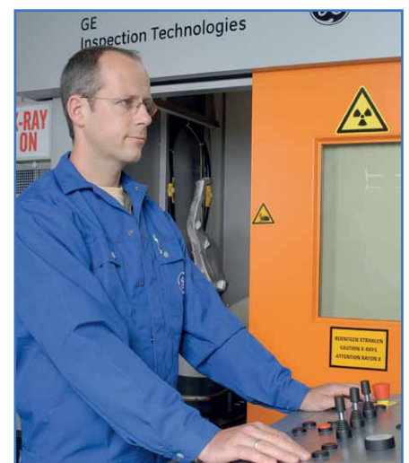
Automatisierte 3D-Porositätsanalyse und CAD-Soll-/Ist-Wert-Vergleich in einem Fahrzeug-Gussteil.
