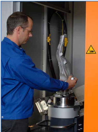
Prüflösungen auch für große Prüfteile: das modulare Konzept der Seifert x|cube Serie erlaubt eine Vielzahl von Kabinen-, Röhren- und Detektorenkonfigurationen
