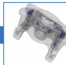
Exakte Fehlerlokalisierung: Virtueller Schnitt durch das 3D-Volumen eines tomographierten Gussteils
