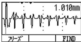
リアルタイムAスコープ表示でより精密な評価が可能に
