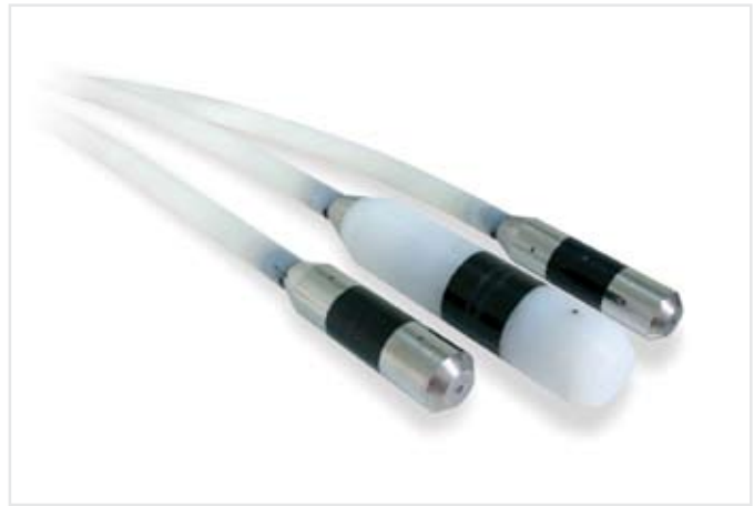
Датчики, использующие вихретоковый метод контроля, для инспекций теплообменных труб из неферромагнитных материалов в рамках предприятия
