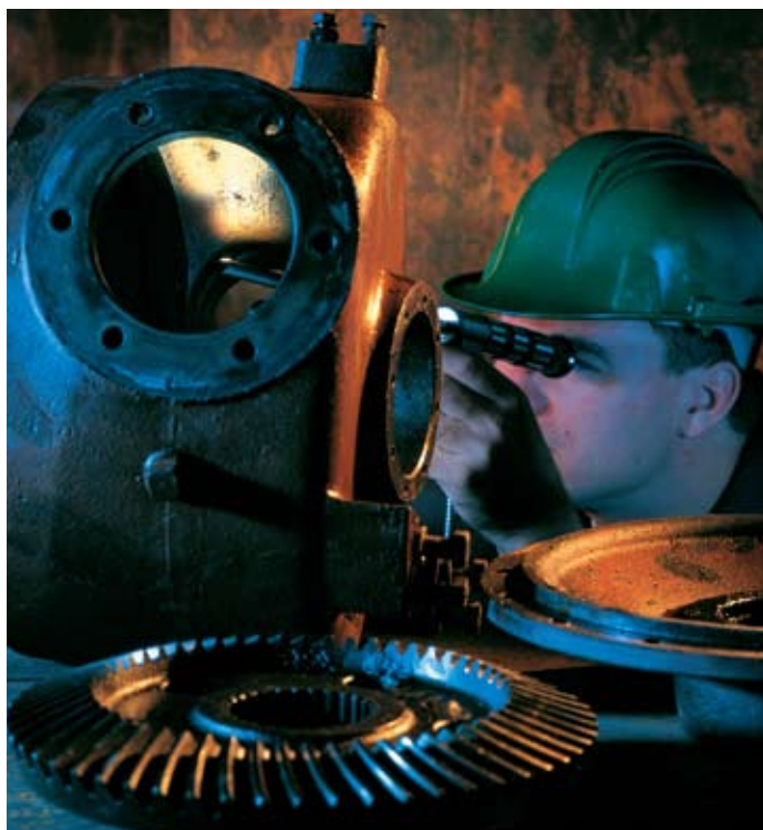
Contrôle de la transmission d'une prise de force avec un endoscope rigide
