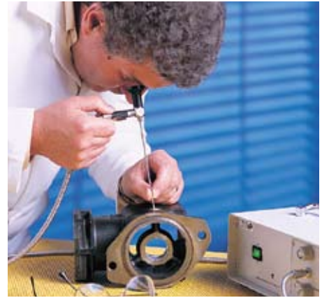
Contrôle du compresseur d'un frein pneumatique après usinage
