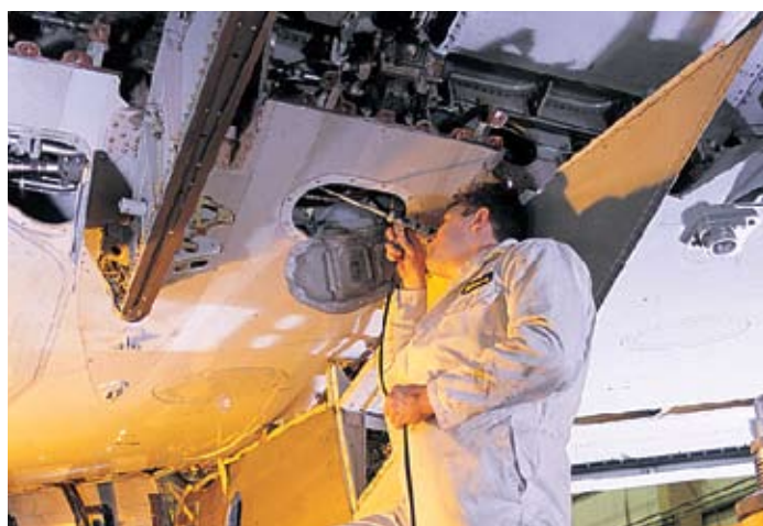
Contrôle d'une zone difficile d'accès dans la structure d'une cellule d'avion
