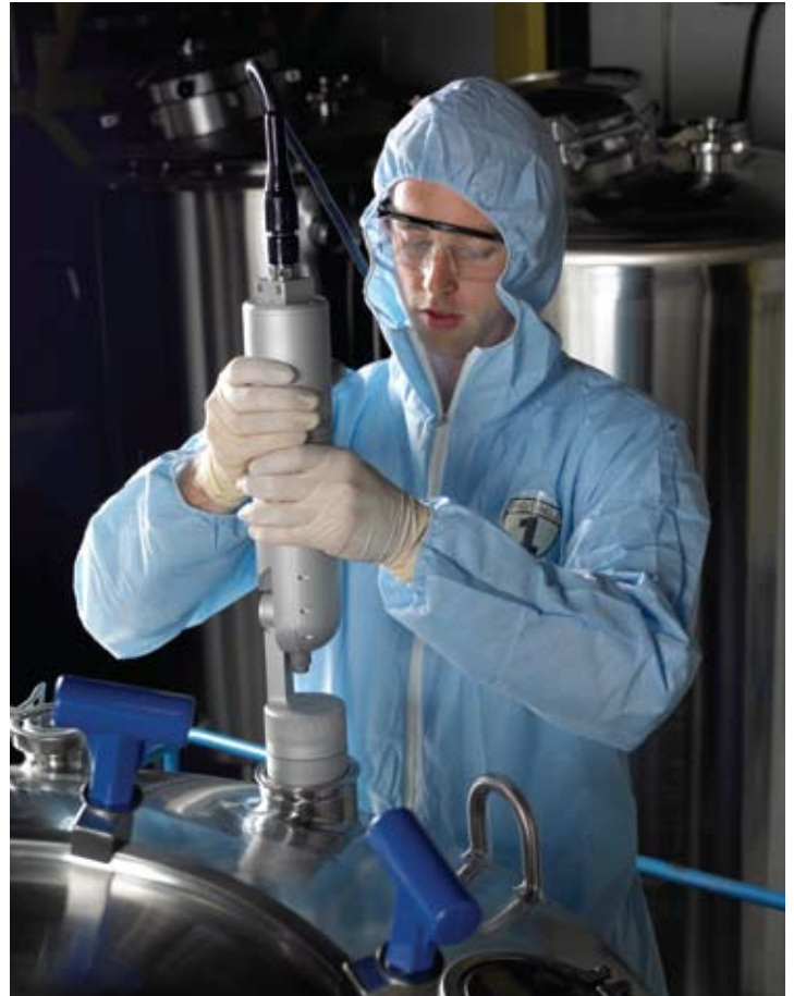
Contrôle d'un réservoir pharmaceutique par une embouchure de 76 mm (3,0")
