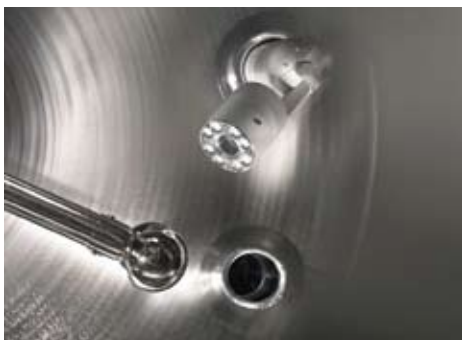
Contrôle de la zone de pulvérisation d'une buse pour la validation d'un nettoyage
