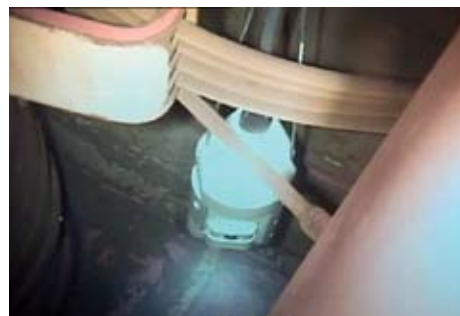
Examen des soudures de la protection du cœur d'un réacteur à eau pressurisée
