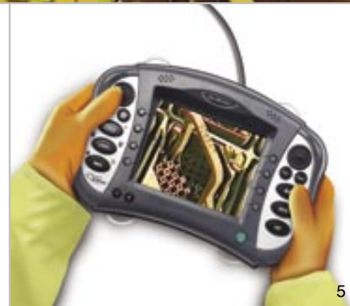
Ablesen der Seriennummer von Brennelementen in einem Reaktor
