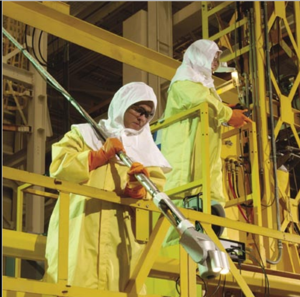
Überwachung eines nuklearen Reaktorbehälters mit der Ca-Zoom™ PTZ
